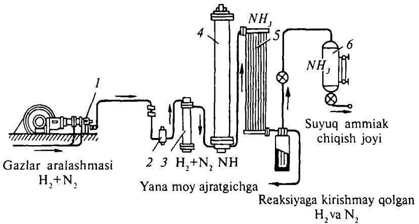
**10.3-rasm.** Sintetik ammiak ishlab chiqarish sxemasi.
