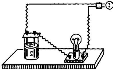
**5.4-rasm.** Eritmalarning elektr o'tkazuvchanligini aniqlash asobi.
